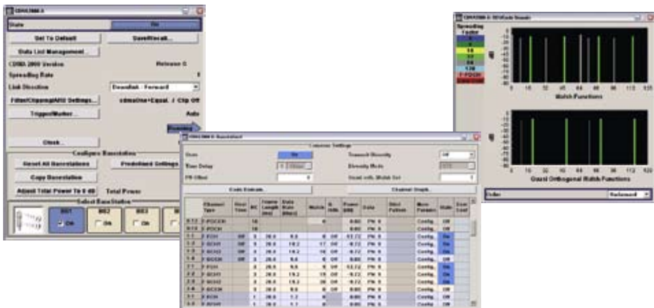
Отображение кодовой области в R&S®SMJ100A с тремя каналами данных HSDPA и соответствующие результаты от анализатора сигналов (кодовая область, перечень каналов и сигнальное созвездие канала данных HSDPA)
